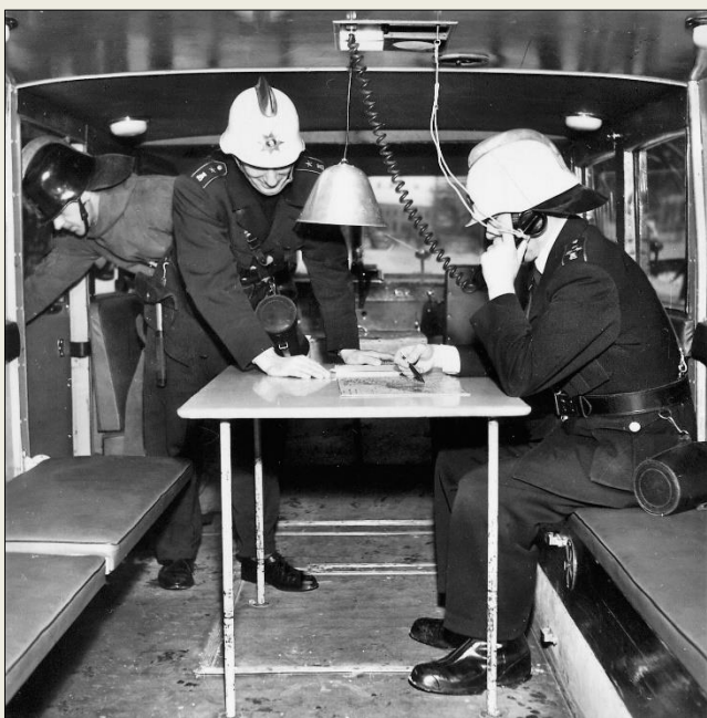
Malmö Brandkårs gamla brandbuss nr 3 byggdes om i början av 1950-talet till katastrofbuss. Som sådan kunde den antingen transportera många skadade på bårar eller apteras som ledningsfordon. Bilden ovan visar hur bussen (SGK 37) används som mobil ledningscentral. Th. visas antennarrangemanget.
