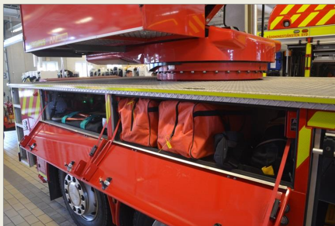
Ovan. Höger sidofack i 1030. Förvaring av diverse verktyg och redskap samt skyddsdräkter i två storlekar.
