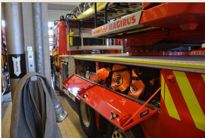
Ovan. Vänster sidofack i 1030. Förvaring av redskap, verktyg och skyddsmateriel för arbete på hög höjd..
