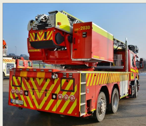
Ovan. Lådan på stegsidan innehåller hoppkudde samt vattenkanon till korgen.
