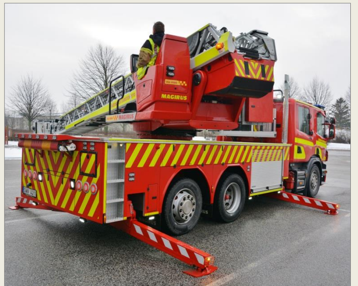
SWN421, 261-1230, utanför vagnhallen till Jägersros brandstationen. Stegen kan sänkas till minus 17 grader, t ex för att plocka upp någon från vattenytan
