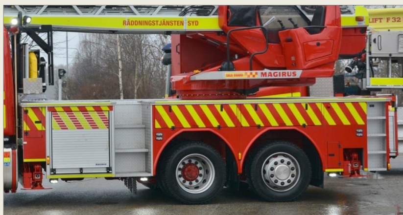
Ovan. Framre sidofacket innehåller rökfläkt.
