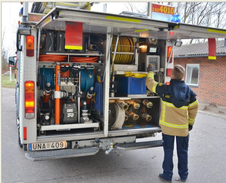
De fyra bilarna ser i stort likadana ut och har samma utrustning. I bakre vänstra skåpet finns ett hydraulaggregat med slangar och redskap för trafikolyckor och liknande. I det högra finns pumpens olika in- och uttag samt slangrulle för snabbinsats.
