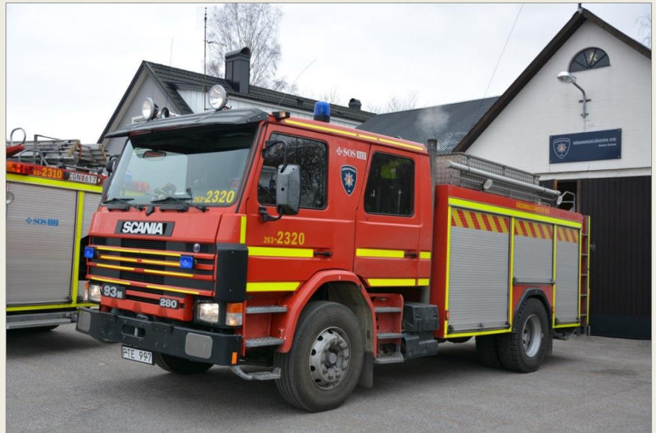
På skåpstaket finns utskjutstege och redskapslåda.
