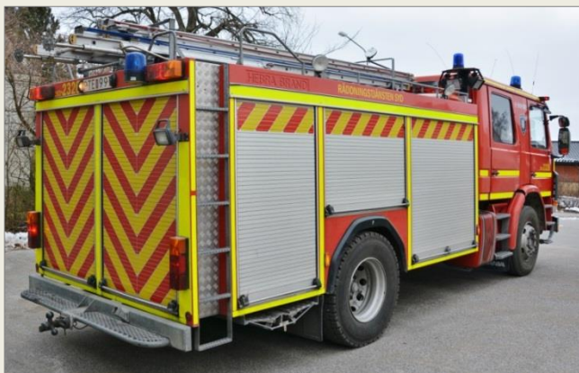
På skåpstaket finns utskjutstege och redskapslåda.
