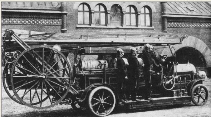
M419/M394 levererades med en avbröstbar 22 m stege av Bergströms fabrikat. Den byttes senare ut mot en 25 m (nedan).
