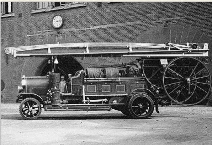
M419/M394 levererades med en avbröstbar 22 m stege av Bergströms fabrikat. Den byttes senare ut mot en 25 m (nedan).
