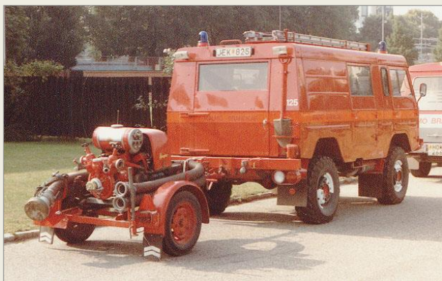
Bil 125 med tillkopplad Zieglerspruta vid stn Heleneholm.
