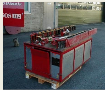
Slangkassetten luckas för slanguttag. Ovanpå finns brandpost och brandpostnyckel. Rymmer 600 m 76 mm slang.
