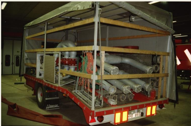
Under pumpsläpets kapell döljer sig en kraftig Rubergpump på 10000 l/min, driven av en Volvo Penta dieselmotor..
