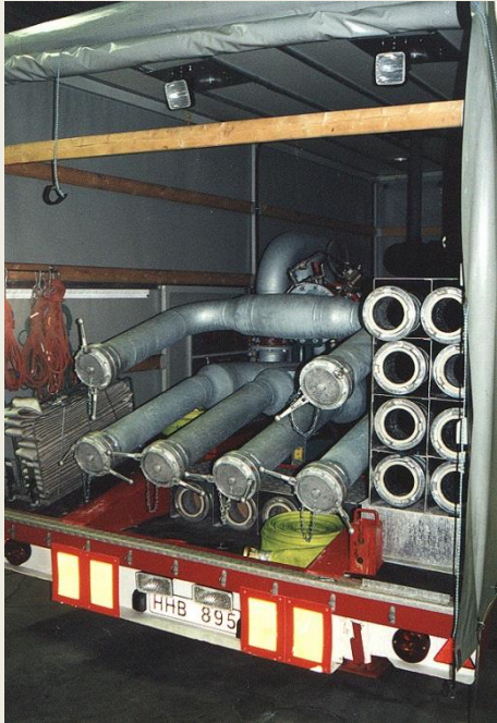
Under pumpsläpets kapell döljer sig en kraftig Rubergpump på 10000 l/min, driven av en Volvo Penta dieselmotor..
