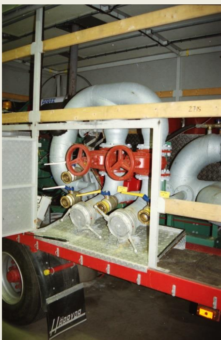
Ovan till vänster. Flera suganslutningar bakåt. Fack med sugslangar på höger sida.
