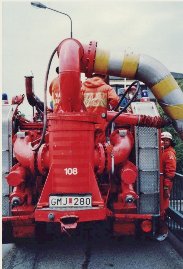
Pumparnas suganordning i närbild..
