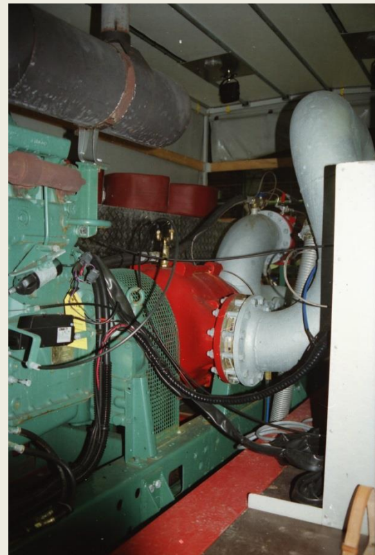
Pumpens drivmotor med kylaranläggning framåt och avgasrör uppåt genom kapelltaget.
