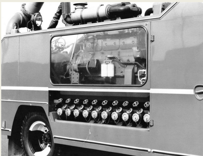
Tio tryckuttag finns på vardera långsidan. Servicelucka i form av ett fönster stillade mångas nyfikenhet.
