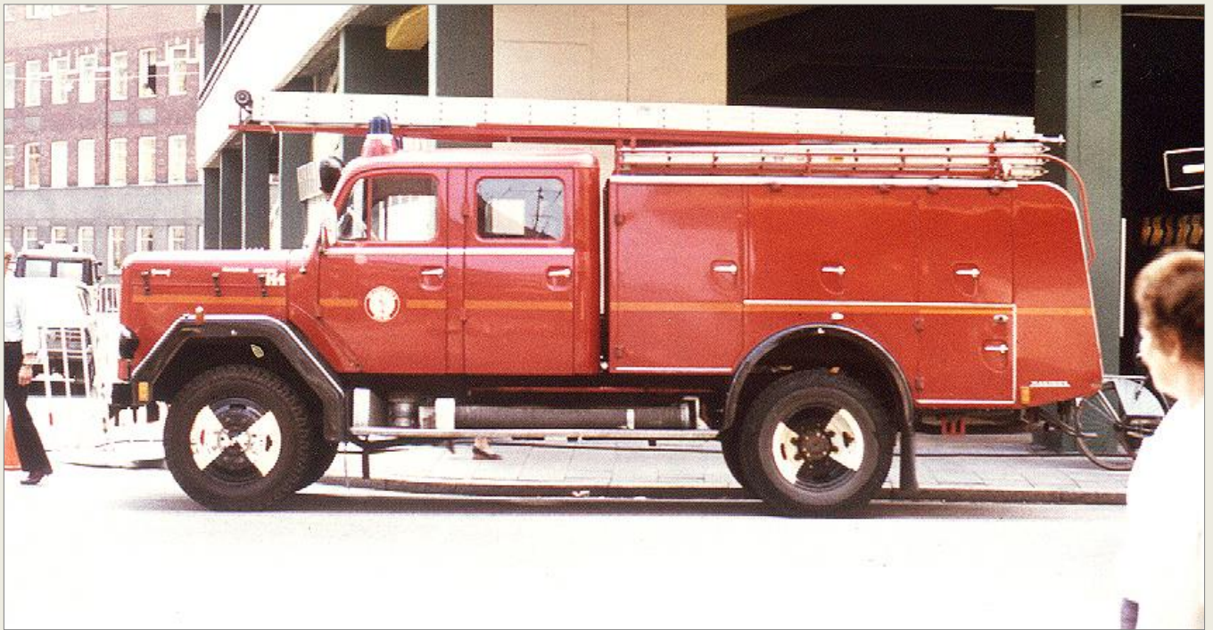
Ovan. Juli 1979. Bil 144 från Limhamnsstationen har fått de vita reflexbanden på sidorna utbytta mot orange dito. Utskjutstegen är 14 m.
