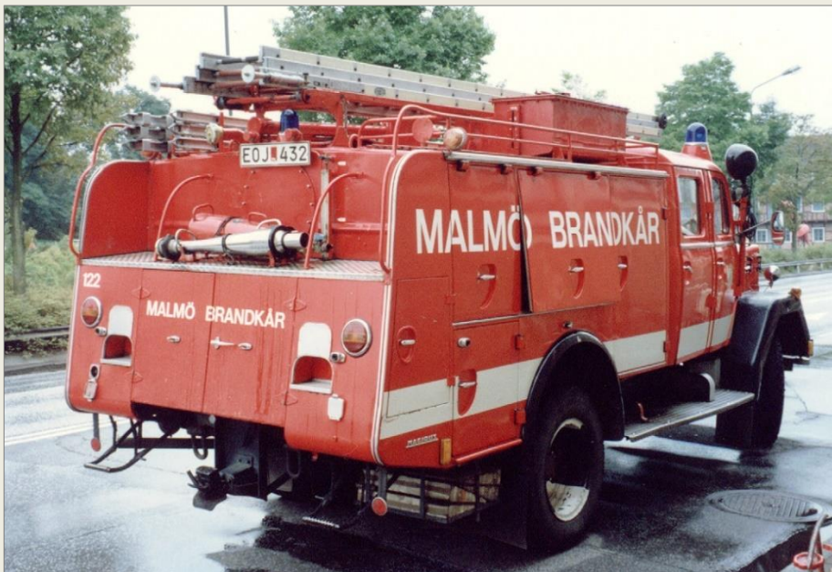
Tv. Bil 122 står här på Citadellsvägen vid en större brand i ett ädelmetallföretag i juli 1992. Man kan här se inbuktningarna i yttre handräcket vilka har skapat funderingar bland många Magiruskännare. Det är ingen ny design utan resultatet av en allt för lång inbackning i Heleneholmstationens vagnhall. Andra våningens gångbro gjorde då dessa avtryck.
